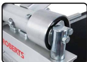
La leva de acero con rodamientos de bolas proporciona un corte suave y potente
